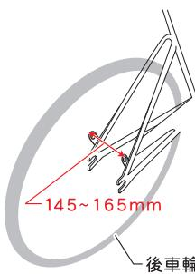
シートクランプはシートピン穴がM6のもので、その周りの直径12mmの範囲に段差が無いもの、またはシートステー上部にダボ穴(M6かM5)があるもの。
