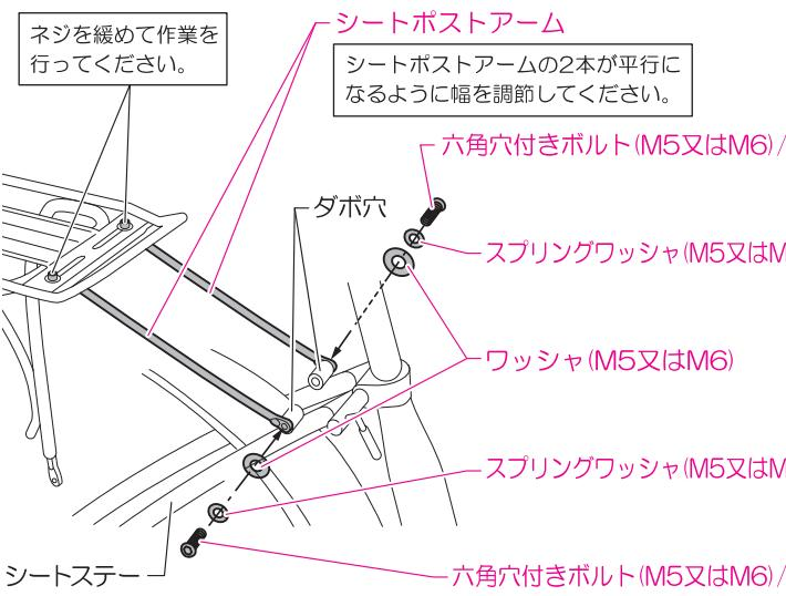
2 高さ調節アームを後車輪のハブ軸付近にあるダボ穴へ**仮止め**します。高さ調節アームの長さは4段階に調節出来ます。
