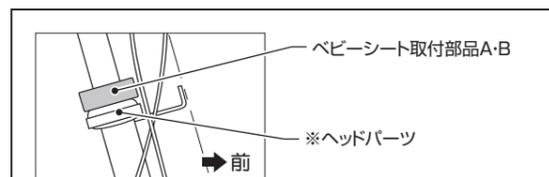
ベビーシート取付部品A・Bの基本取付位置は自転車のヘッドパーツ上面にベビーシート取付部品A・B下面が乗るところです。
