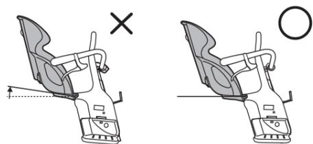
注意 ●自転車に取付けた時に、座面(お子さまが座る部分)が地面に対して前に傾く自転車には取付けないでください。
