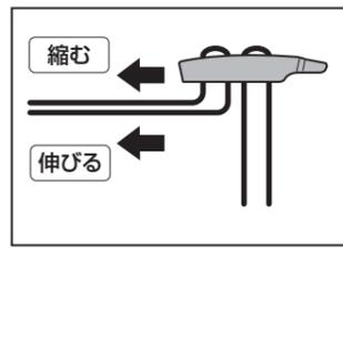
ラダーロックを持ち上げて、ベルトの長さを調節してください。(※左右とも)
