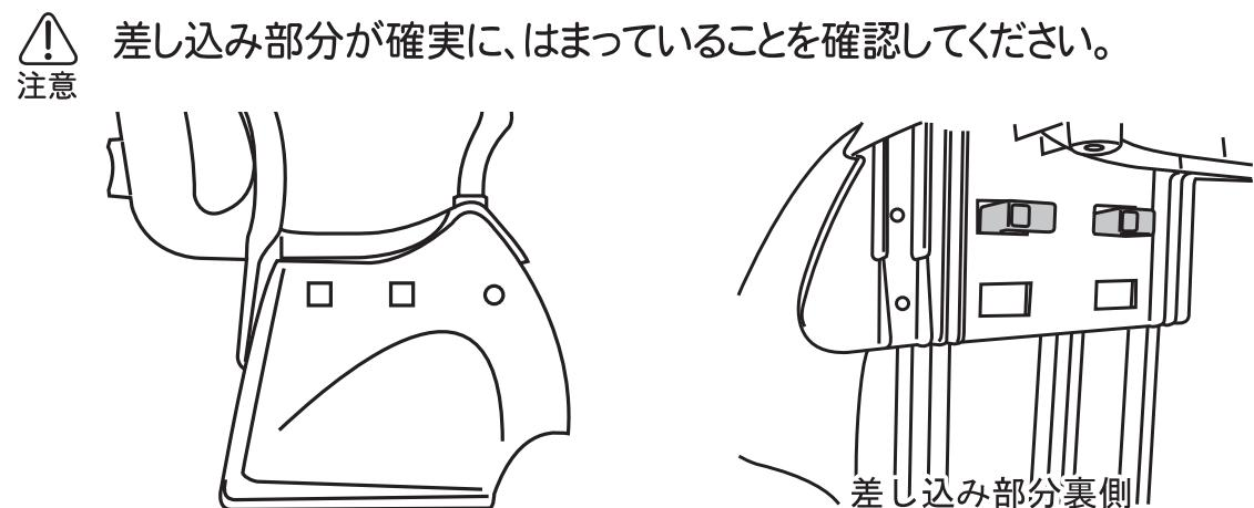
⑤ 安全ベルトをリヤチャイルドシート本体の安全ベルト通し穴に通します。
