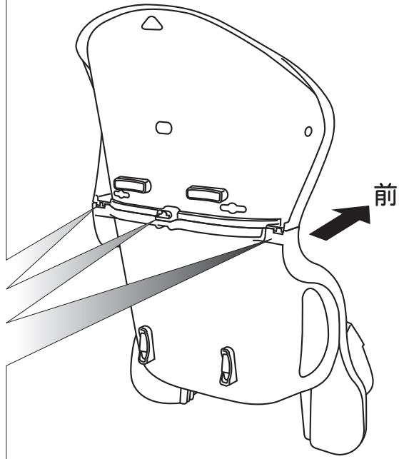
③ ステップ右とステップ左を本体のステップ用穴に差込んで、15mm程度後方へスライドさせます。
