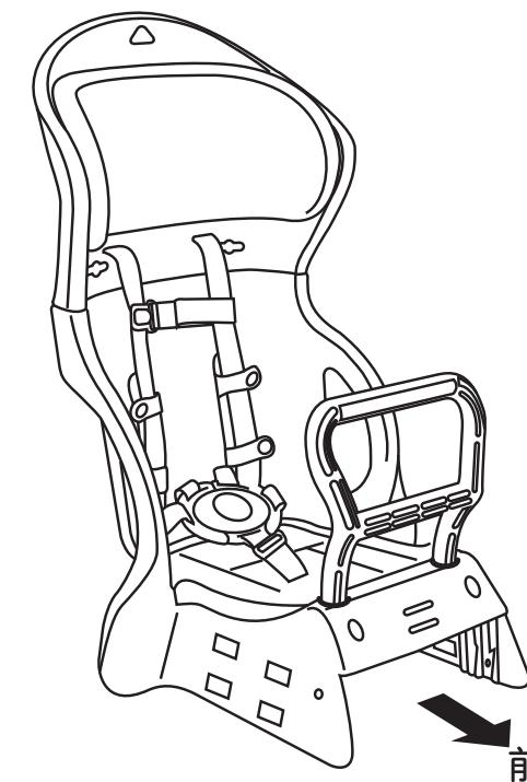
② リヤチャイルドシート本体の上部と下部を後ろ側で板ナットと固定ネジ(M5)を使って、しっかりと固定します。
