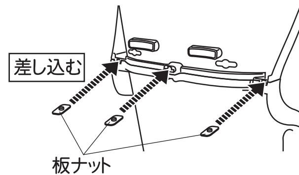
2.固定ネジ(M5)でしっかりと固定します。(3箇所)
