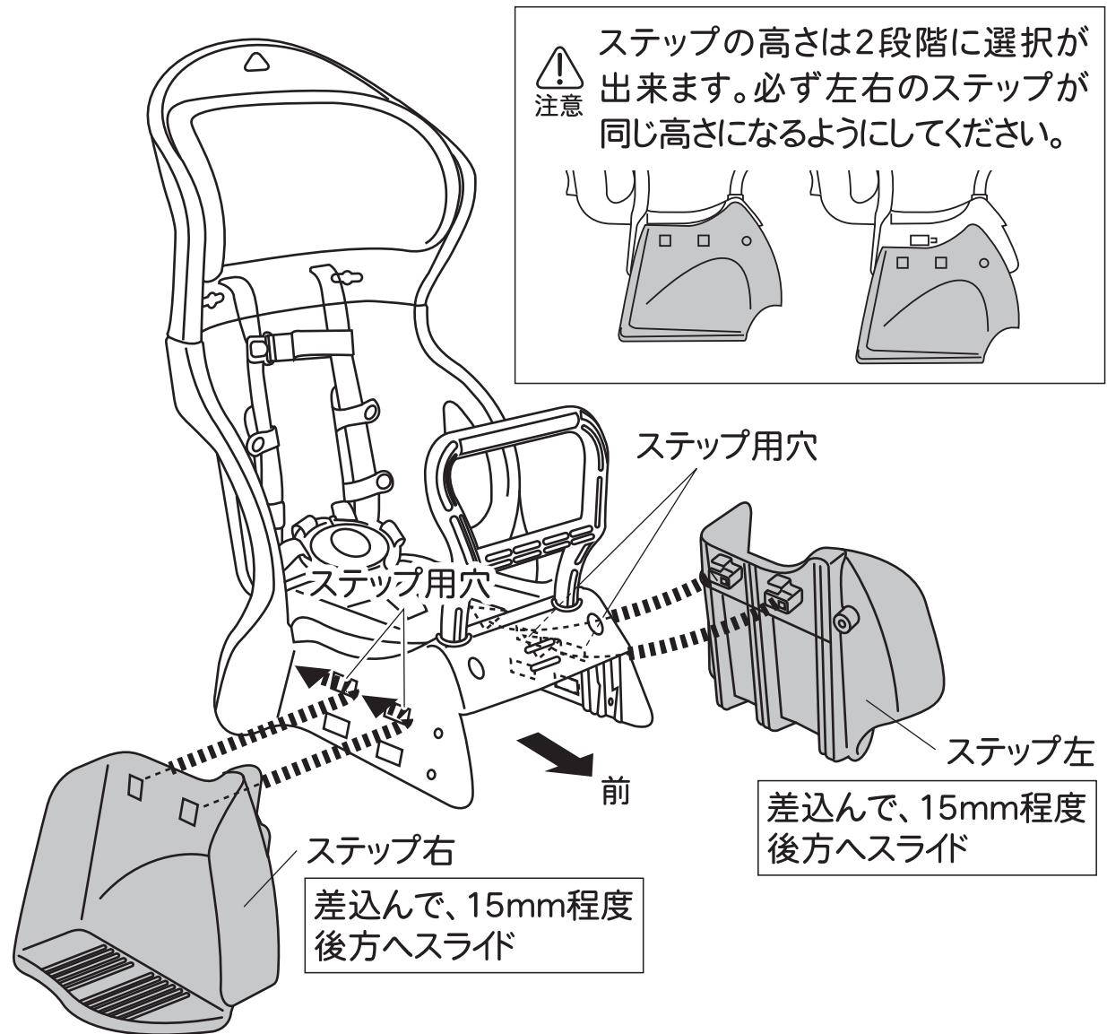
④ ステップ右とステップ左を固定ネジ(M5)と板ナットでしっかりと固定します。
