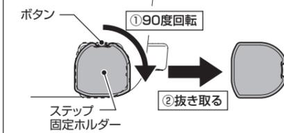
取付け時は、必ず90度回転して固定してください。
