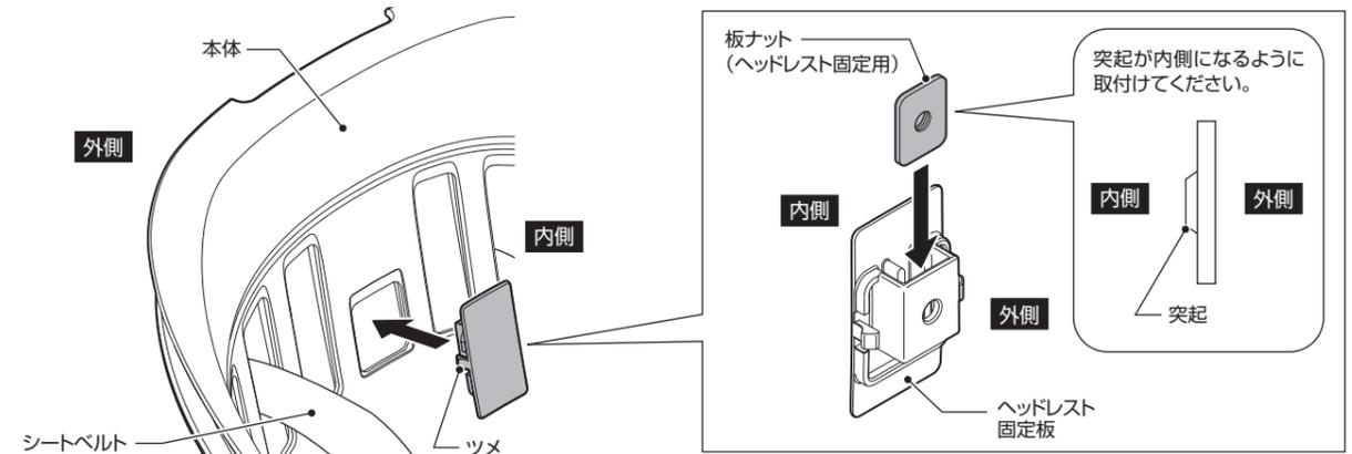
2. ヘッドレストを一番高い位置に移動して、ヘッドレストのツメ2ヶ所を本体背面の穴に差込んでヘッドレスト固定ネジでしっかり固定してください。
