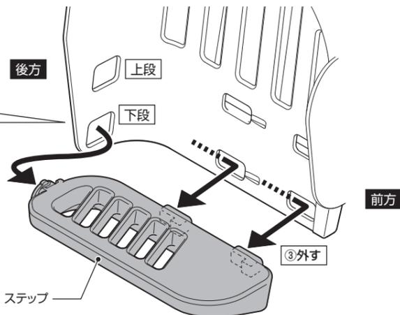
左右のステップの高さが必ず同じ高さになるようにしてください。
