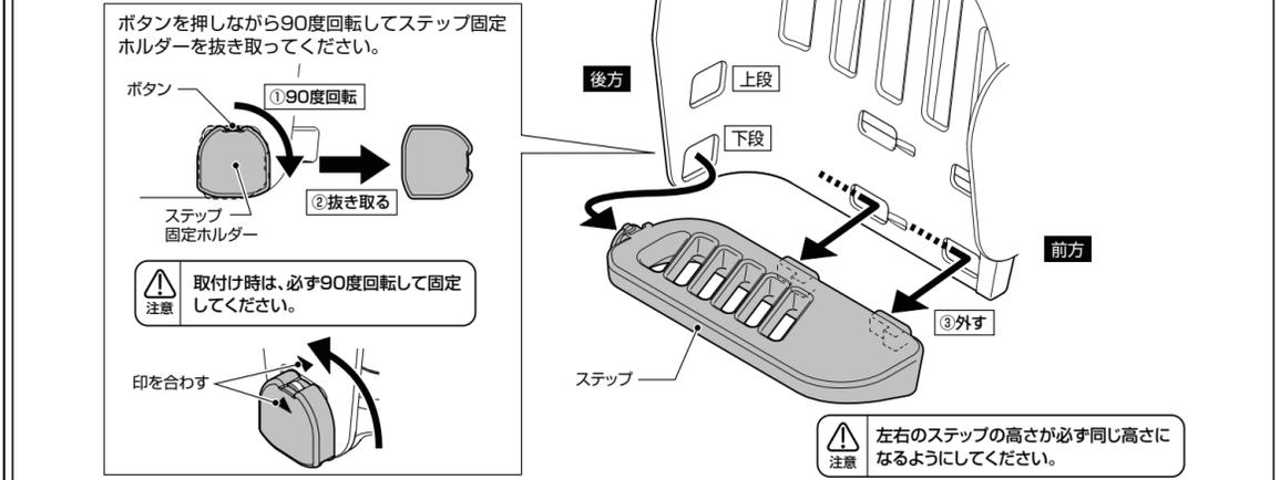
取付け時は、必ず90度回転して固定してください。
