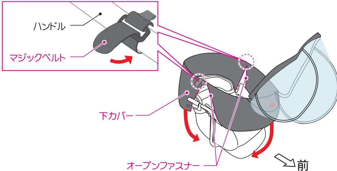
2 付属の粘着付マジックテープの粘着部分をチャイルドシート背面と下カバーのマジックテープが合う位置に貼り、取付けます。
